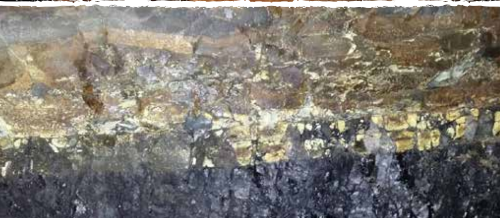
Contacto entre el manto n. 4 de carbón (parte inferior), y las areniscas sedimentarias (parte superior) en el interior de la mina Chiflón del Diablo (Lota).
